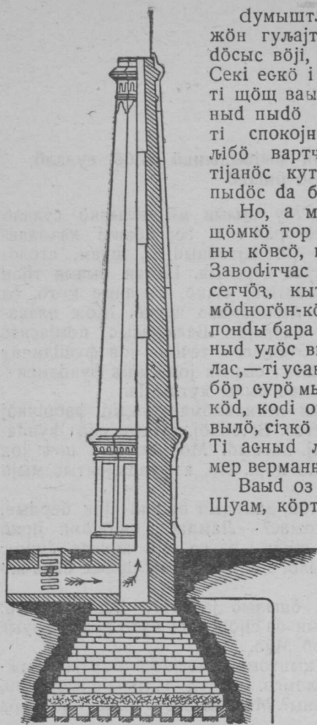
1 сөр. Фабрика труба мыжсө фон фундамент вылө.
